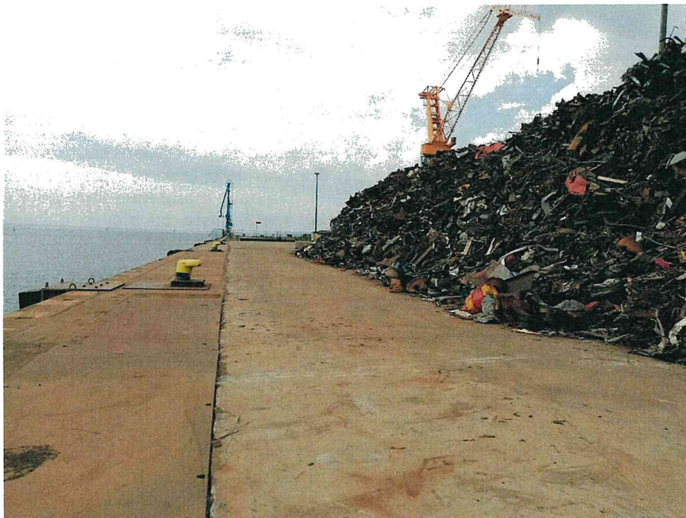
Photo 2 : tas de ferrailles cisailées (vu coté quai). Noter la distance réglementaire de 6,5 m entre le bord du tas et le bord du quai
